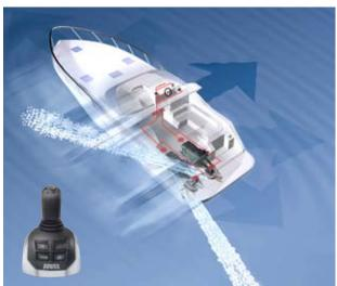
Avec le joystick le pilote peut manœuvrer le bateau à vitesse basse. Le joystick est couplé à un logiciel sophistiqué et particulièrement développé qui commande individuellement les moteurs et les unités pour manœuvrer et changer de marche et d'accélération. Le joystick vous permet de manœuvrer dans toutes les directions (latérale, diagonale, avant, arrière, rotation) avec une seule main. Connectez-vous sur volvopenta.com pour en juger par vous-même!
